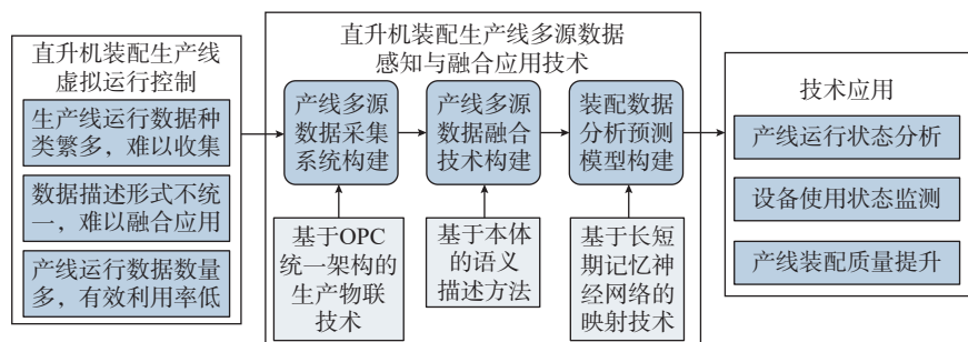
图1 直升机装配生产线多源数据感知与融合应用技术框架
